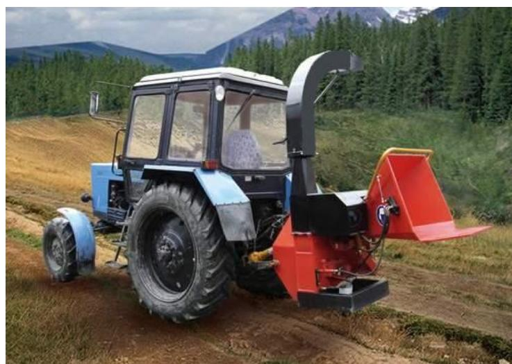
Рубительная машина РМ160Т агрегатируется с тракторами Т-70, ЮМЗ-6, МТЗ-80/82 (Беларус) и другими аналогичного класса, с мощностью от 80 л.с., которые имеют вал отбора мощности.
